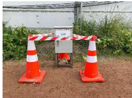
รูปที่ 24 ติดตั้งเครื่องตรวจวัดคุณภาพสิ่งแวดล้อม (คุณภาพอากาศ ระดับเสียง เสียงรบกวน และความสั่นสะเทือน)
