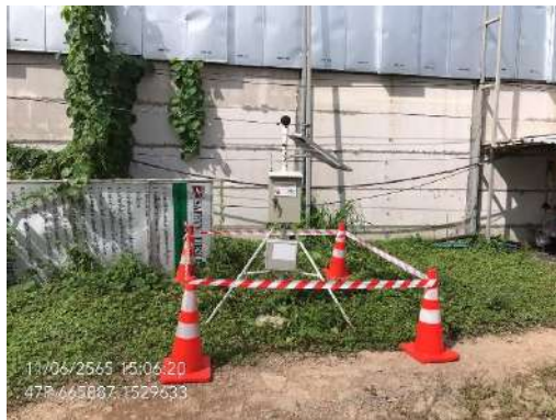
รูปที่ 24 ติดตั้งเครื่องตรวจวัดคุณภาพสิ่งแวดล้อม (คุณภาพอากาศ ระดับเสียง เสียงรบกวน และความสั่นสะเทือน)
